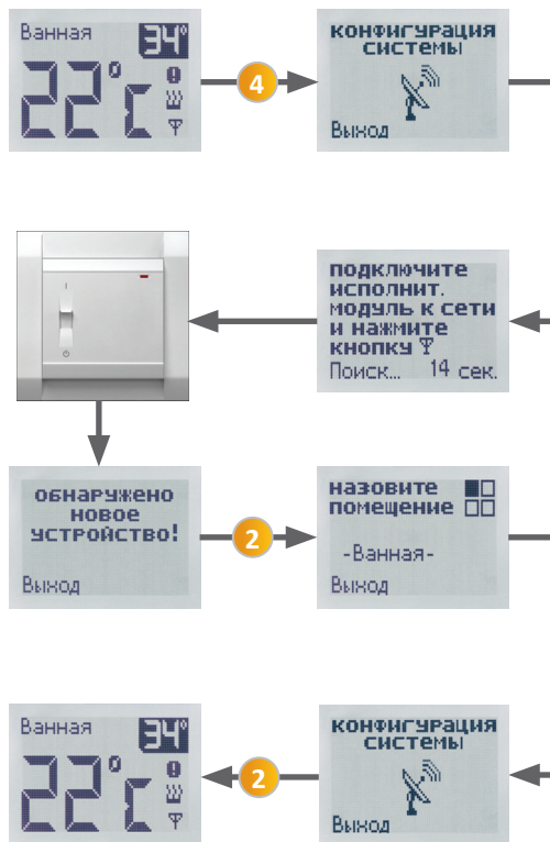
Рис. 29. Схема переключения по пунктам меню при подключении дополнительных модулей к системе
