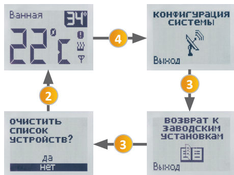
Рис. 41. Схема переключения по пунктам меню при восстановлении заводских установок
