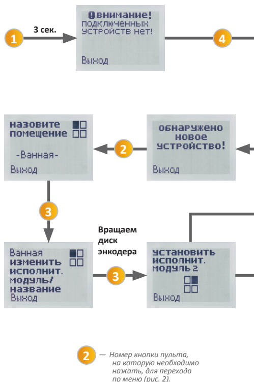
Рис. 18. Схема переключения по пунктам меню настройки при первом включении системы TP 810
