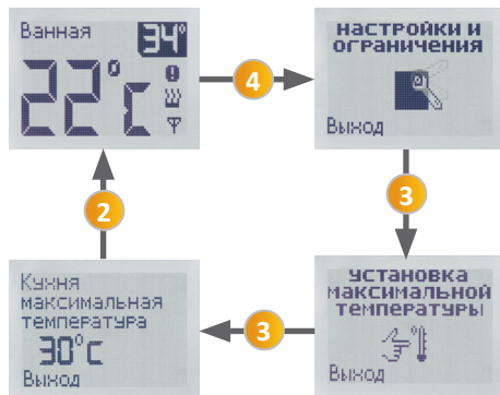
Рис. 37. Схема переключения по пунктам меню при установке максимальной температуры обогрева
