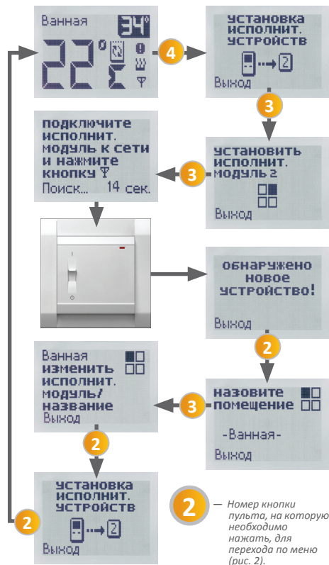
Рис. 28. Схема подключения дополнительных модулей к системе TP 820
